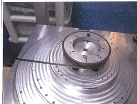
16. 馬達角度和量測的磁場數值測試 0 - 360° (測試完成)
