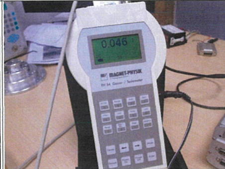
14. 馬達角度和量測的磁場數值測試 0 - 360° (測試中)
